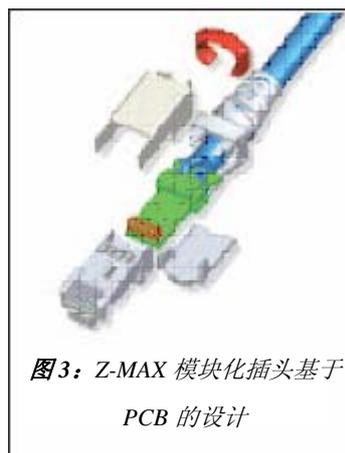
图3：Z-MAX 模块化插头基于 PCB 的设计
