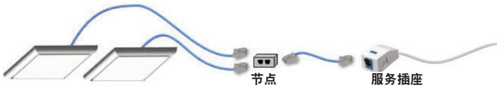
A: 2x2 节点中心式 - 两个2x2灯盘共享一个节点，该节点通过服务插座（SO）或服务集合点（SCP）连接到结构化布线
