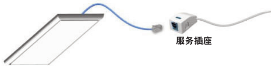
D: 2x4 照明装置中心式 - 每个2x4灯盘通过服务插座（SO）或服务集合点（SCP）连接到结构化布线
