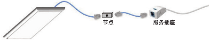
B: 2x4 节点中心式 - 每个2x4灯盘独享一个节点，该节点通过服务插座（SO）或服务集合点（SCP）连接到结构化布线
