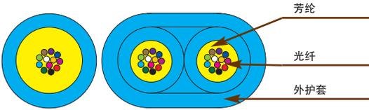
减少线缆直径 - 简化安装并使数据中心的通道空间最大化
