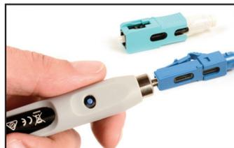
**VFL检测工具** – 连接器内置的窗口与0.5mW输出功率的1类激光VFL配合使用，可验证端接是否良好。如果需要，可以调整或重新端接。
