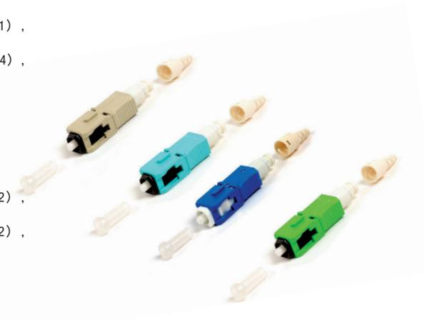
**注:** 仅可用于900 $\mu$ m紧套缓冲光纤的端接。扇出式光纤套件的缓冲层是从250 $\mu$ m转接到900 $\mu$ m的,不可以使用LightBow连接器端接。
