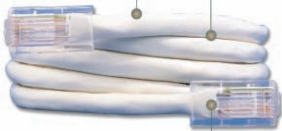
**模块化插头** - 超过 FCC CFR 47 第 68 部分第 F 子项和 IEC 60603-7 规范，镀镍针脚上有 50 微英寸的镀金层
