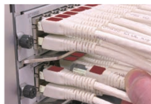
高密度 创新“推拉”护套使密集环境下插除跳线非常容易
