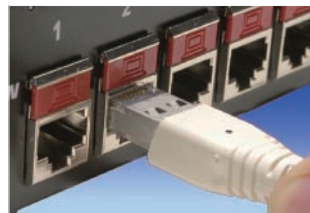
通用兼容性设计 适合标准RJ45 插座
