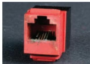
**湿度对插座的影响** - 潮湿会腐蚀插座中的接触针，若经常性暴露在潮湿中，这些接触针最终将被破坏从而使整个插座失去功用。而西蒙加固型插座的独特外壳可以防止这种侵蚀
