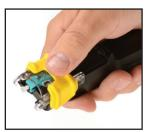
符合人体工程学设计 — 既可手持使用,也可通过防滑橡胶脚垫固定在桌面上使用
