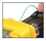
绝佳的可靠性 — 借助弓形特性 在光纤末端保持适当压力,从而 在端接过程中消除气隙
